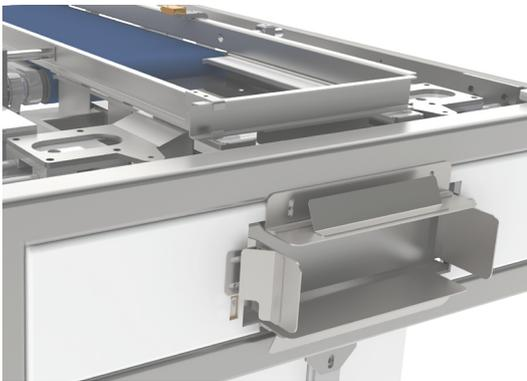
Servogesteuerte Linearantriebe geben höchste Flexibilität bei der Realisierung unterschiedlichster Stapelschemata und reduzieren den Aufwand beim Formatwechsel nahezu auf einen Tastendruck. Zuverlässigkeit und fehlerfreier Lauf sind die Kriterien, nach denen dieser Kartonierer konstruiert wurde und gebaut wird. Dies spiegelt sich auch in der verwendeten Steuerung der neuesten Generation wider.
